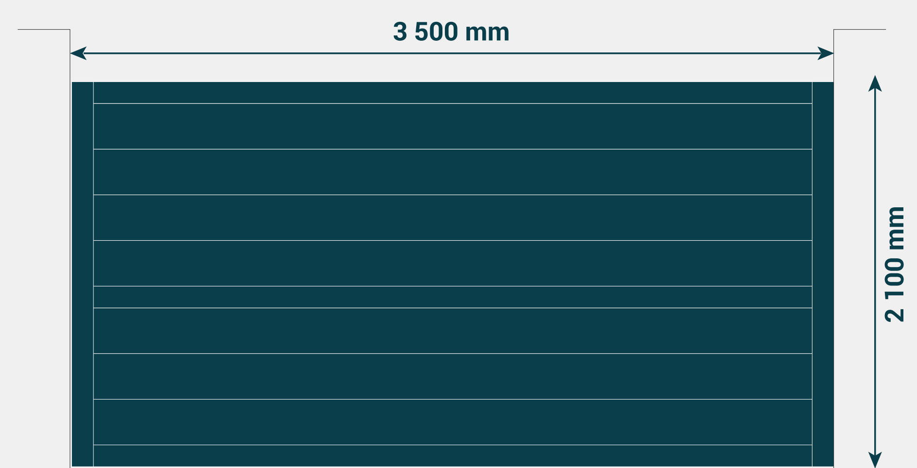
Dimensions maximales du coulissant
